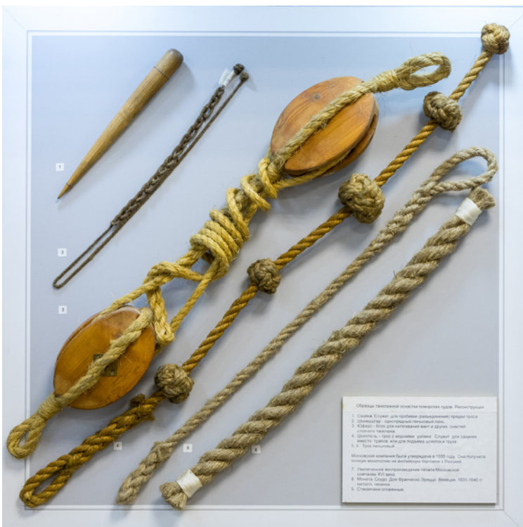
Образцы такелажной оснастки торговых судов. Реконструкция.
